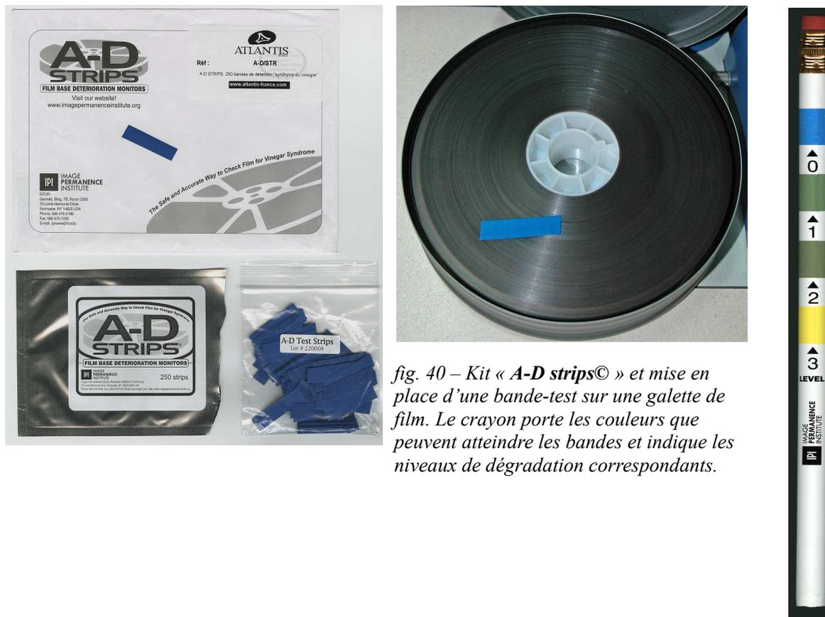
fig. 40 – Kit « *A-D strips*® » et mise en place d'une bande-test sur une galette de film. Le crayon porte les couleurs que peuvent atteindre les bandes et indique les niveaux de dégradation correspondants.
