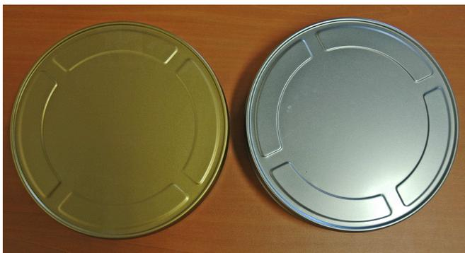
Fig. 35 – boîtes en acier vernis époxyde teinté or et incolore.
