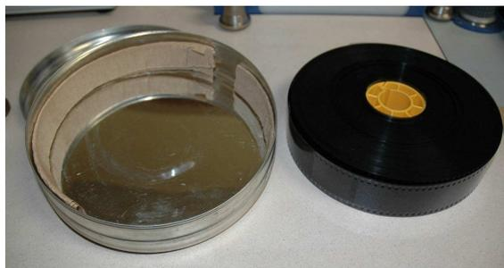
fig. 39 – Un papier disposé pour caler la galette, peut-être en papier neutre ou peut-être pas... : dans le doute on élimine.
