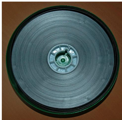
fig. 34 – Microfilm dans une boîte en polypropylène. Le noyau est bloqué dans ses déplacements horizontaux par des pattes centrales. L'air circule autour de la galette.
