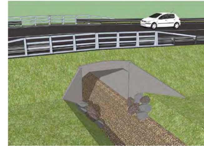
Vue 3D de principe de l'ouvrage
