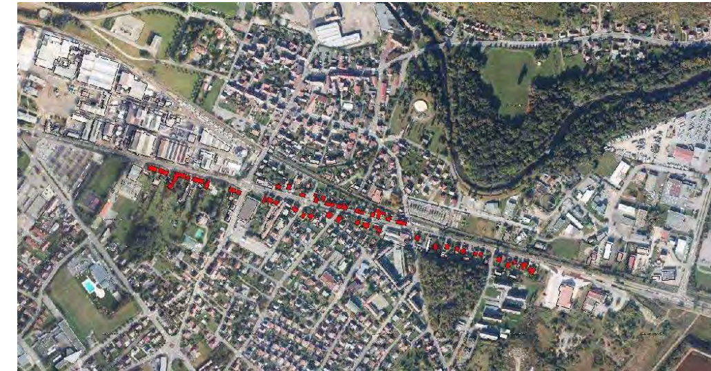
Figure 18 : Vieux-Thann : 45 bâtiments, situés de part et d'autre de la RN 66, dépassent les seuils acoustiques (source : PPBE du Haut-Rhin, octobre 2012)
