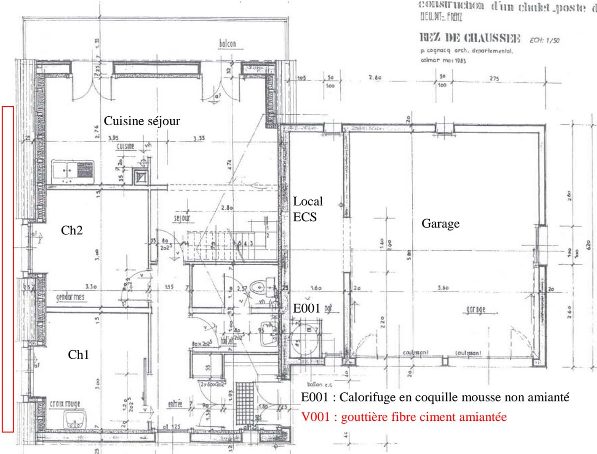
E001 : Calorifuge en coquille mousse non amianté
