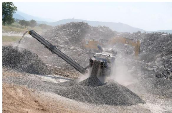
Après fracturation de la dalle de roulement, les morceaux de dalle évacués ont été transformés en granulats sur le terrain de la base vie du chantier, pour être revalorisés en terre-plein central et bande d'arrêt d'urgence de l'A35.
