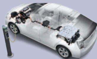
La technologie la plus répandue concernant les batteries de traction est l'alimentation au lithium Ion (Li-ION). Il existe par ailleurs quelques véhicules en circulation fonctionnant au lithium métal polymère (LMP).
