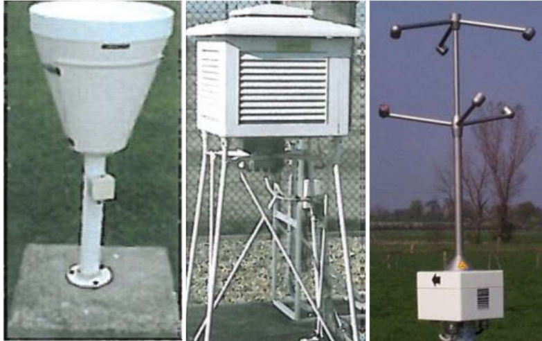
Exemples de matériels pour la mesure de la pluviométrie, de la température et du vent © EDF
