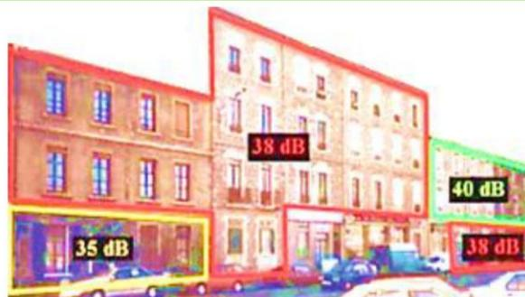
Le renforcement de l'isolement acoustique d'une façade peut être une exigence réglementaire au regard du classement sonore des voies lorsqu'un nouveau bâtiment se construit à l'intérieur du périmètre de nuisance d'une voie classée ou une mesure de résorption dans le cadre du traitement des Points Noirs Bruits destinée à améliorer le confort acoustique en garantissant à l'intérieur des bâtiments un ressenti moindre des bruits extérieurs issus des transports terrestres.
