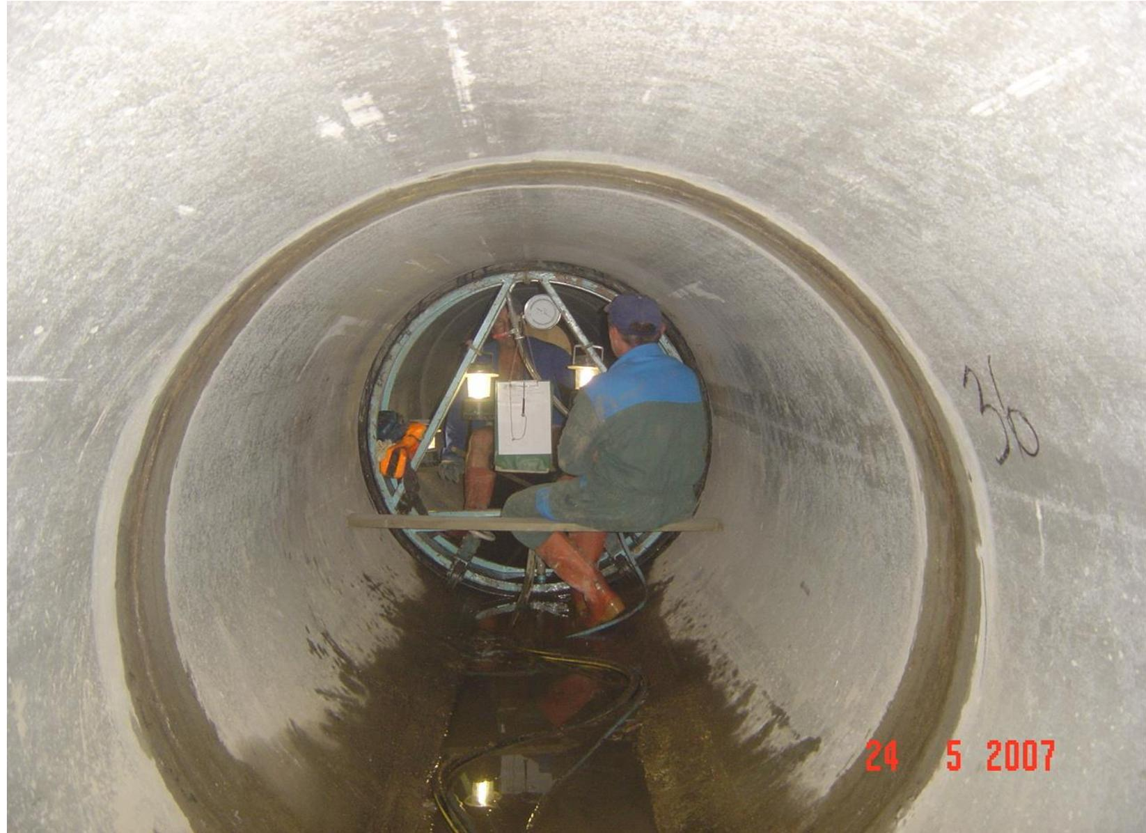
Test d'étanchéité joint par joint sur un collecteur d'assainissement
