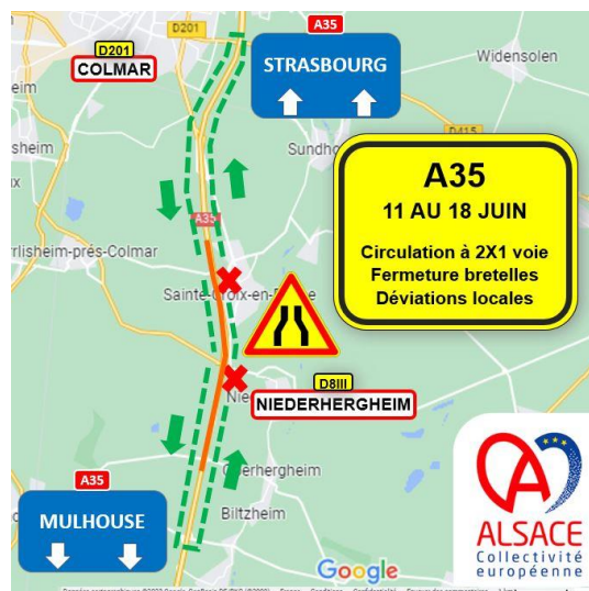
Plan des travaux, phase 2.
