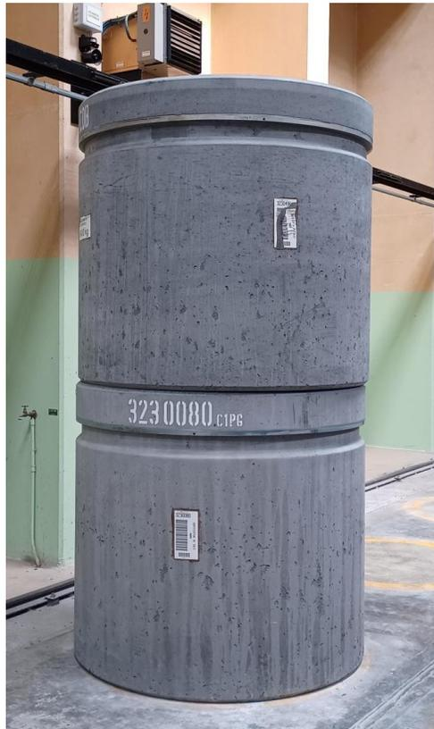
Colis bloqués avec un liant hydraulique sur le site de production puis expédiés au CSA
