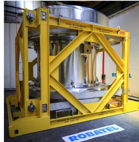
Conteneur-navette R73 muni de ses capots et mis en place dans son châssis de transport
