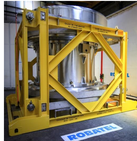
Conteneur-navette R73 muni de ses capots et mis en place dans son châssis de transport
