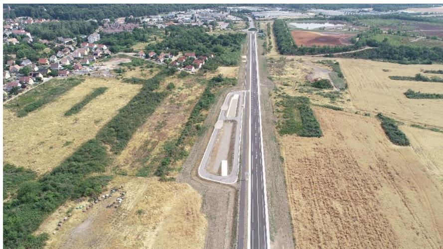
Section nord réalisée avec 1 bassin de rétention et 1 bassin d'infiltration des eaux pluviales.
