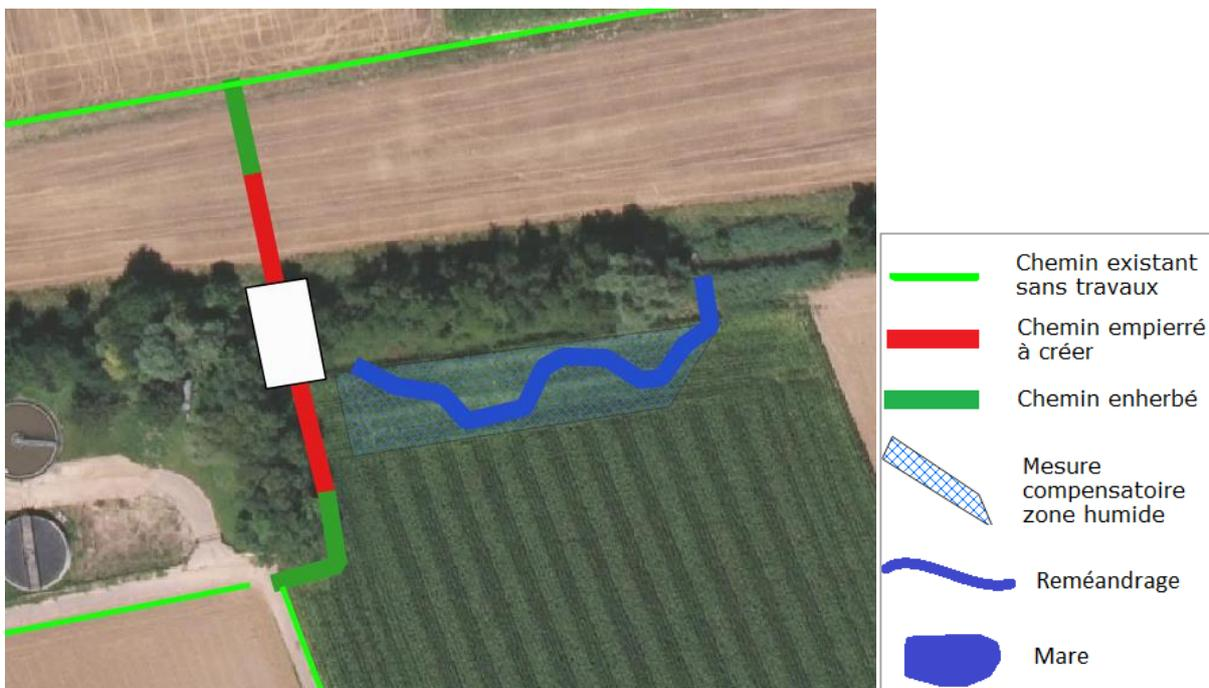
**Pont n°3 sur la SOUFFEL à STUTZHEIM-OFFENHEIM :** reméandrage du cours d'eau sur 80 mètres de long et mesure compensatoire ZH de 800 m<sup>2</sup>.
