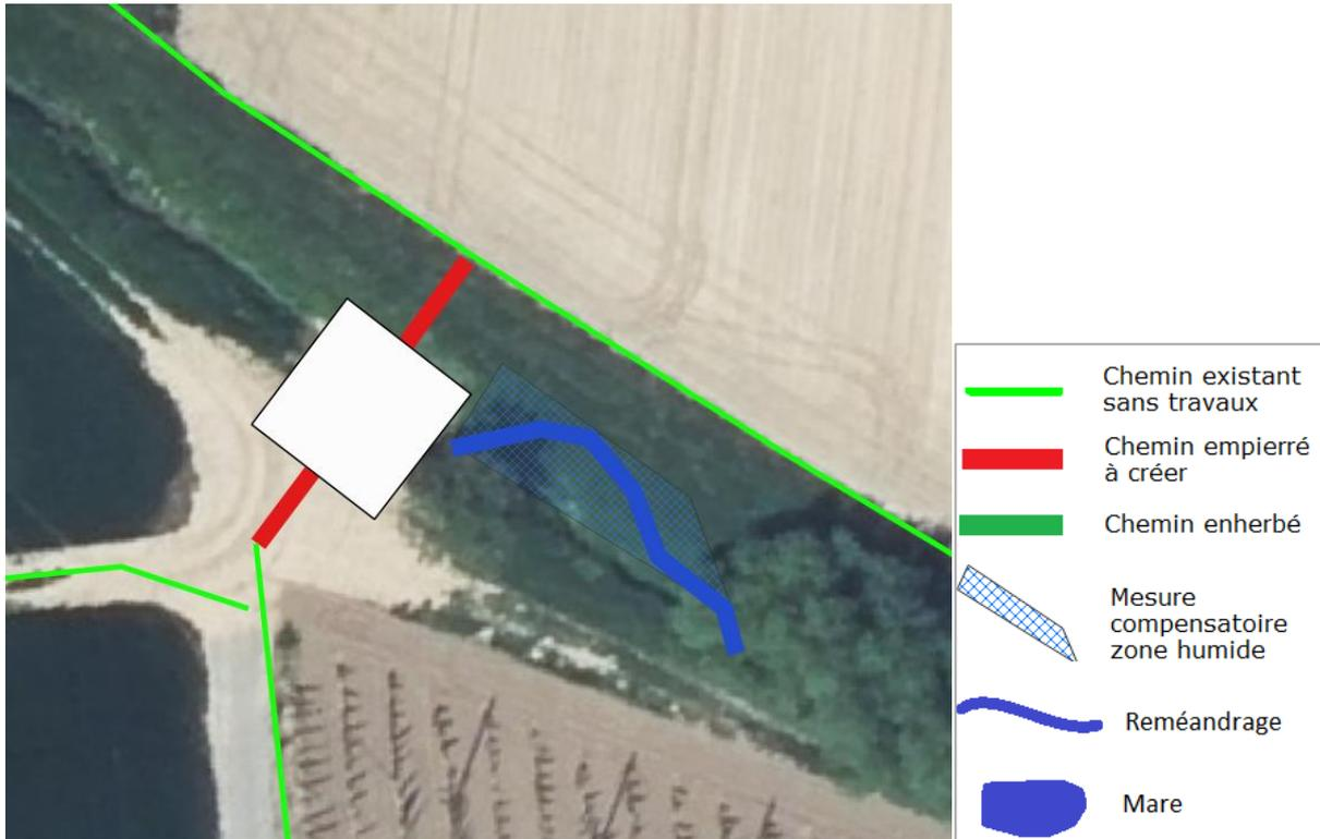
**Pont n°4 sur le MUSAUBACH entre ITTENHEIM et HURTIGHEIM** : reméandrage du cours d'eau sur 25 mètres de long et mesure compensatoire ZH de 100 m<sup>2</sup>.
