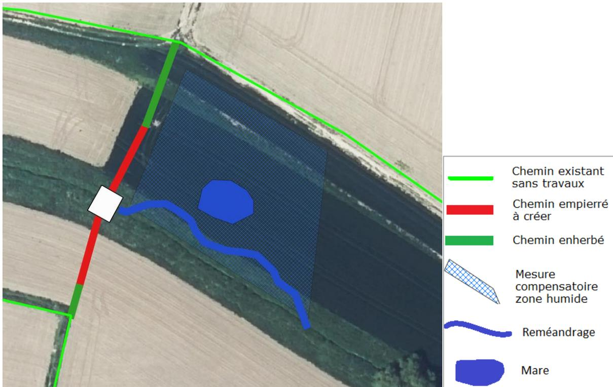
**Pont n°2 sur le KOLBSENBACH entre PFULGRIESHEIM et LAMPERTHEIM :** reméandrage du cours d'eau sur 65 mètres de long et mesure compensatoire ZH de 2000 m<sup>2</sup> au lieu de 1000 m<sup>2</sup> initialement prévu. Création d'une mare.
