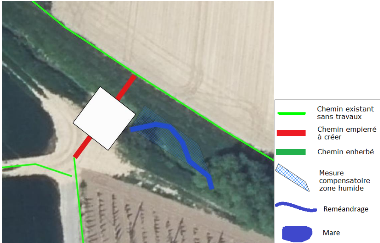
Pont n°4 sur le MUSAUBACH entre ITTENHEIM et HURTIGHEIM : reméandrage du cours d'eau sur 25 mètres de long et mesure compensatoire ZH de 100 m 2 .
