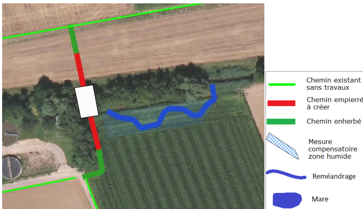
Pont n°3 sur la SOUFFEL à STUTZHEIM-OFFENHEIM : reméandrage du cours d'eau sur 80 mètres de long et mesure compensatoire ZH de 800 m 2 .
