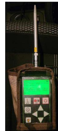
ILLUSTRATION 1 : BATCORDER 3.1 ECOOBS GMBH UTILISÉ POUR LES ULTRASONS DES CHIROPTÈRES © EGIS 2022
