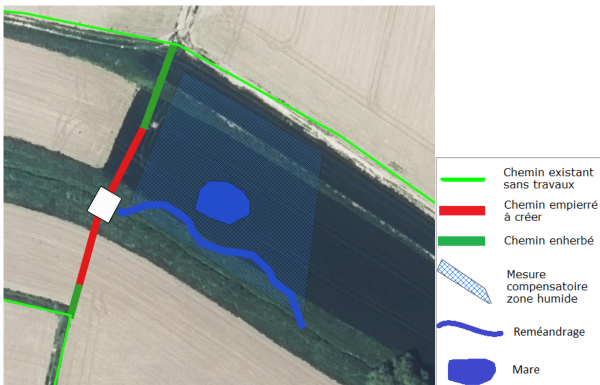
Pont n°2 sur le KOLBSENBACH entre PFULGRIESHEIM et LAMPERTHEIM : reméandrage du cours d'eau sur 65 mètres de long et mesure compensatoire ZH de 2000 m 2 au lieu de 1000 m 2 initialement prévu. Création d'une mare.
