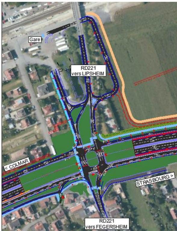
Aménagé sur la tranchée couverte, il permet de rétablir la liaison entre Lipsheim et Fegersheim, notamment pour les modes doux vers le pôle multimodal de la gare, actuellement interrompue par la RD1083. Il intègre également la reconfiguration et l'amélioration du fonctionnement du carrefour d'accès à la gare.
