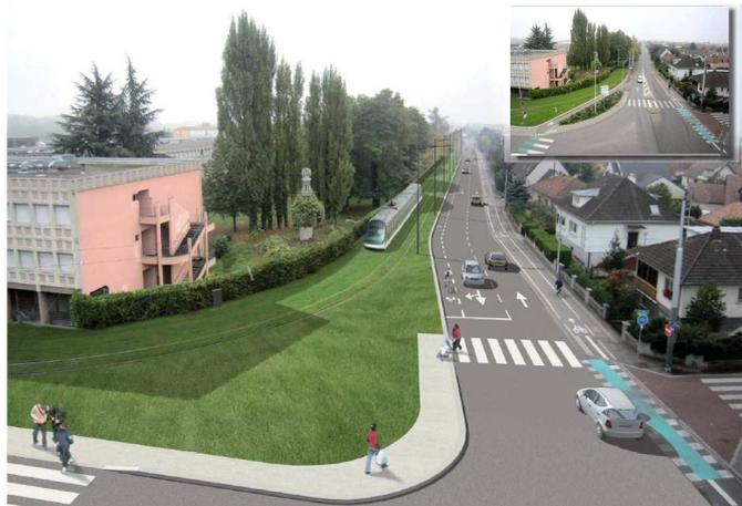
L'insertion de la plateforme tram nécessitera un reculement d'environ 5 m de la clôture du lycée (sans acquisition foncière dans la mesure où la bande de terrain impactée appartient déjà à la CUS).
